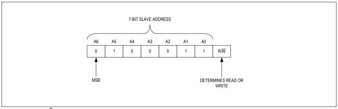
Figure 9. DS2477 I<sup>2</sup>C Slave Address
