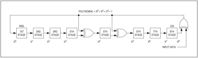
Figure 4. 8-Bit CRC Generator
