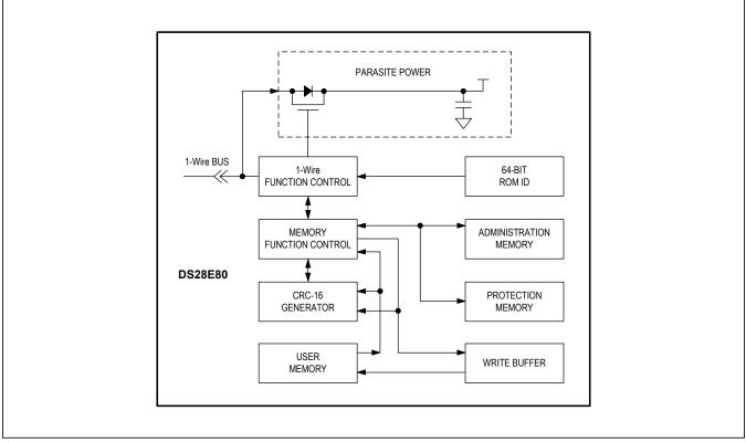
Figure 1. DS28E80 Block Diagram
