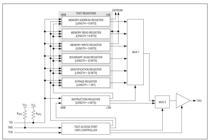
Figure 3. DS4550 JTAG Block Diagram
