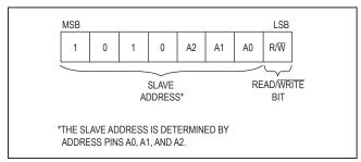
Figure 2. DS4550 I<sup>2</sup>C Slave Address Byte
