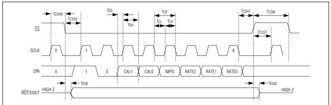
Figure 5. SPI Command Byte
