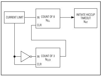
Figure 3. Hiccup-Mode Block Diagram
