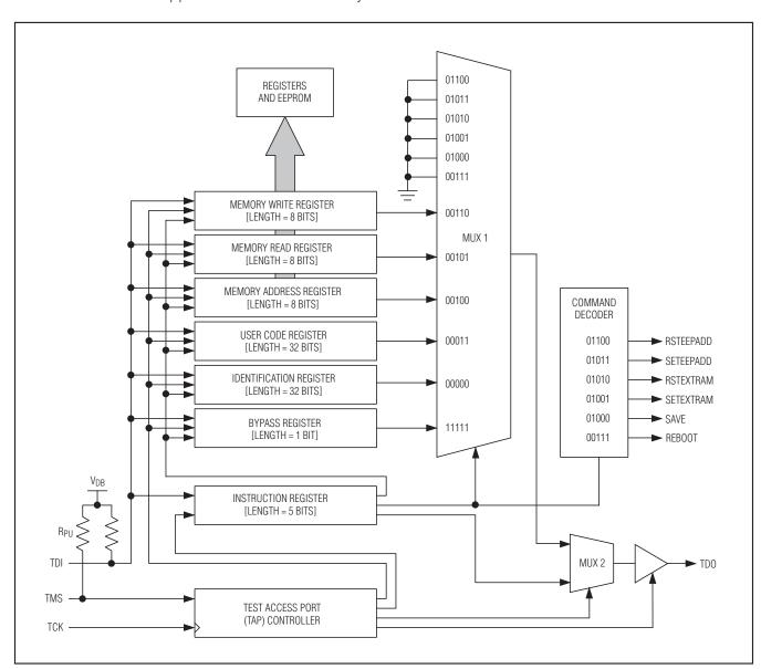
Figure 13. JTAG Block Diagram
