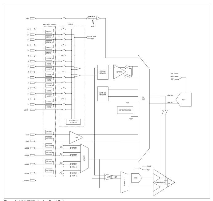
Figure 3. MAX17852 Analog Front-End
