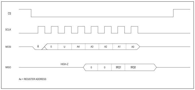
Figure 20. SPI Fast Read Cycle
