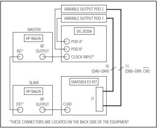
Figure 1. MAX5854 EV Kit Quick-Start Setup
