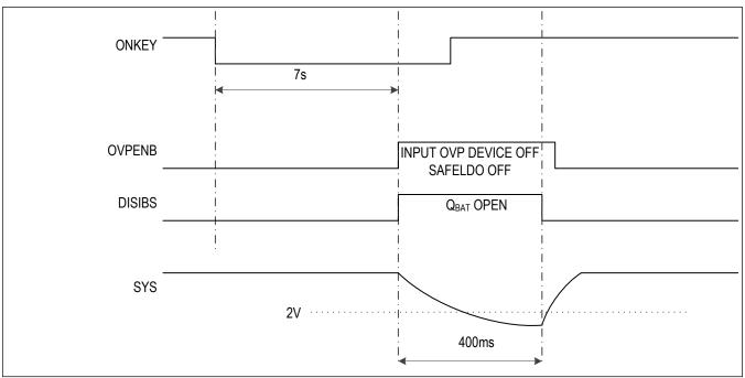
Figure 19. ONKEY Timing Diagram
