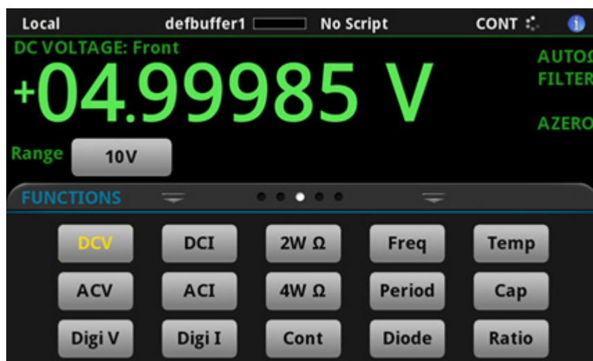
Рис. 33. Результаты измерений напряжения постоянного тока с высокой точностью
