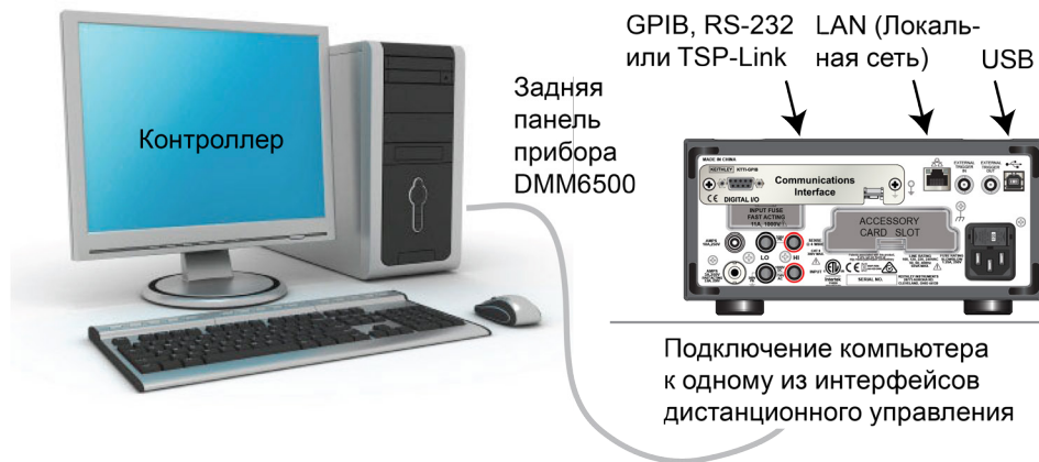
Рис. 15. Подключения интерфейсов дистанционного управления прибором DMM6500
