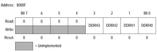
Figure 24. Data Direction Register H (DDRH)
