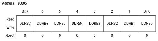
Figure 6. Data Direction Register B (DDRB)
