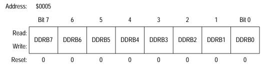
Figure 15-6. Data Direction Register B (DDRB)
