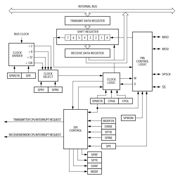
Figure 18-2. SPI Module Block Diagram
